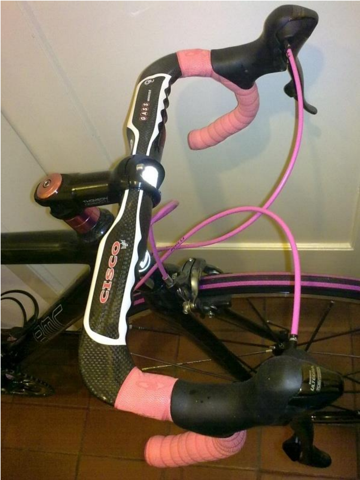
Eksempel på montering hvor kun bremsekablerne er inde i styret (fx Rynkeby model 2010). Jeg ville køre styrbåndet helt rundt i hjørnet, så det mindst dækkede den første hvide streg.
